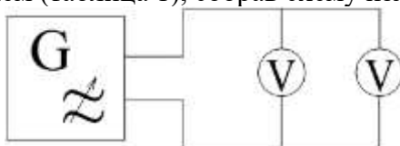
Рисунок 1 – Схема измерения для проверки шкалы прибора В3-38
