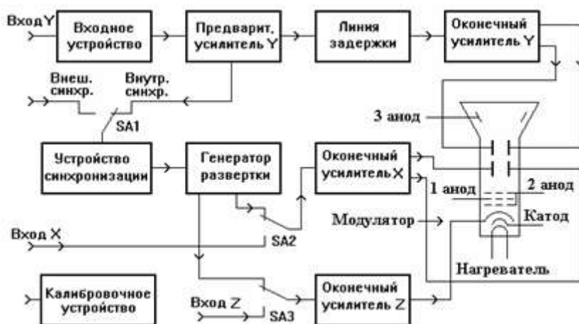
Рис 5.2. Структурная схема осциллографа.
